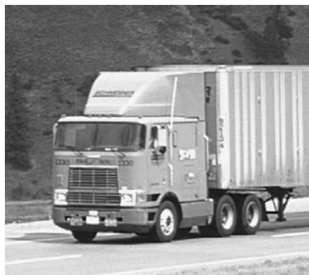
▲ FIGURA 4.23 Superficie aerodinámica La superficie sobre el techo de la cabina de este camión hace aerodinámico al vehículo y así reduce la resistencia del aire, volviéndolo más eficiente.
