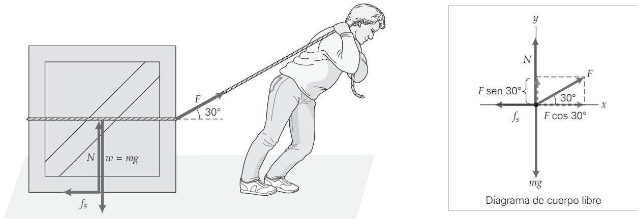
▲ FIGURA 4.21 Tirar en dirección inclinada: un análisis más profundo de la fuerza normal Véase ejemplo 4.11.
